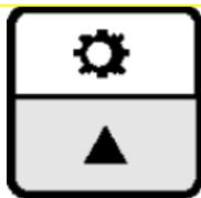
Manuelles Ein- und Ausschalten der Hintergrundbeleuchtung (siehe Konfigurationsmodus für Optionen). Es kann zwischen niemals „NEVER“, 10 Sekunden, 30 Sekunden, 1 Minute und 5 Minuten gewählt werden. Mit der Option „NEVER“ bleibt die Hintergrundbeleuchtung dauerhaft eingeschaltet solange das Gerät angeschaltet ist bzw. bis die Taste Hintergrundbeleuchtung erneut betätigt wird. Ansonsten schaltet sich die Hintergrundbeleuchtung nach der vorgegebenen Zeit selbständig aus.
